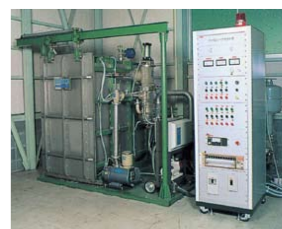
▼気密漏洩検査設備
